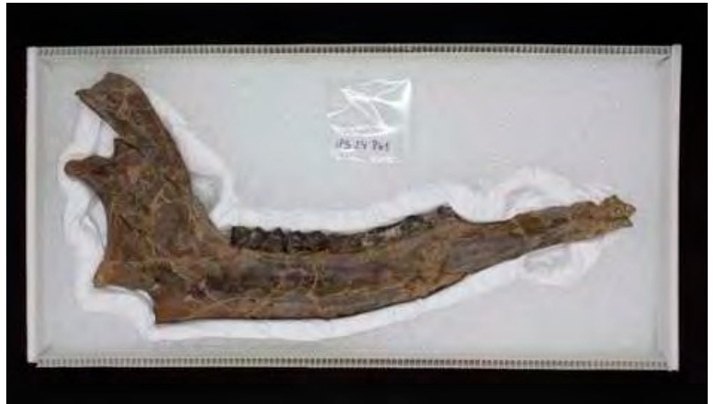
Caixa feta a mida amb planxes de polipropilè cel·lular per a embalar un exemplar paleontològic (oberta) (Institut Català de Paleontologia Miquel Crusafont).
